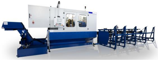
Die Bearbeitung des Rohrs beginnt ab Stange. Der Transfer bearbeitet das äussere Abdrehen, inneres Drehen, Anfasen und das Gewinderollen.
