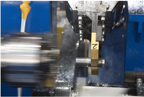
Oben: Befestigungen für den Heizungs- und Lüftungsbereich Unten: WAGNER Z27-2 Rollkopf in Arbeit
