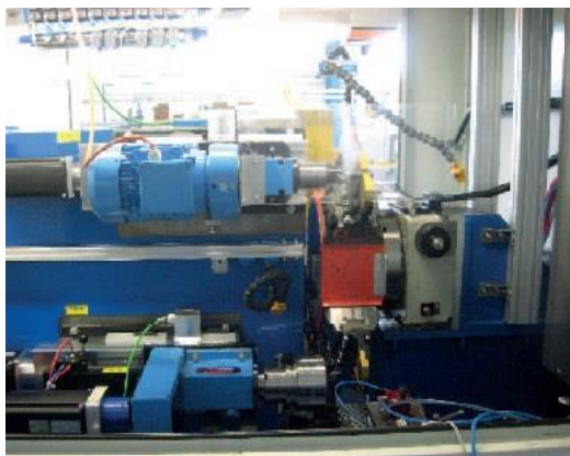
Unidad especial SUHNER BEX35 ISO40 con cabezal WAGNER Z27-2 y unidad BEX15 Weldon
