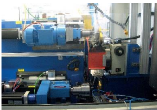
Unité spéciale SUHNER BEX35 ISO40 avec tête à rouler WAGNER Z27-2 et BEX15 Weldon
