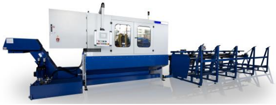
La lavorazione del tubo parte della barra. Il transfer esegue le lavorazioni di tornitura esterna, tornitura interna, intestatura e filettatura a rullare
